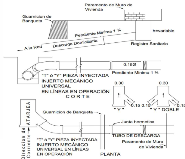
Registro tipo de drenaje sanitario
